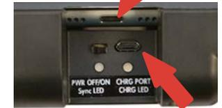
Akku-Ladebuchse für den Gehäuselautsprecher
