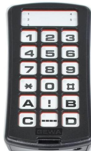
3. Drücken Sie kurz die Taste
