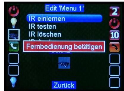
Halten Sie nun die Fernbedienung vor den IR Empfänger des PILOT touch und drücken die gewünschte Taste. Wenn ein Signal empfangen wird, erscheint ein blinkendes Symbol im Display.
